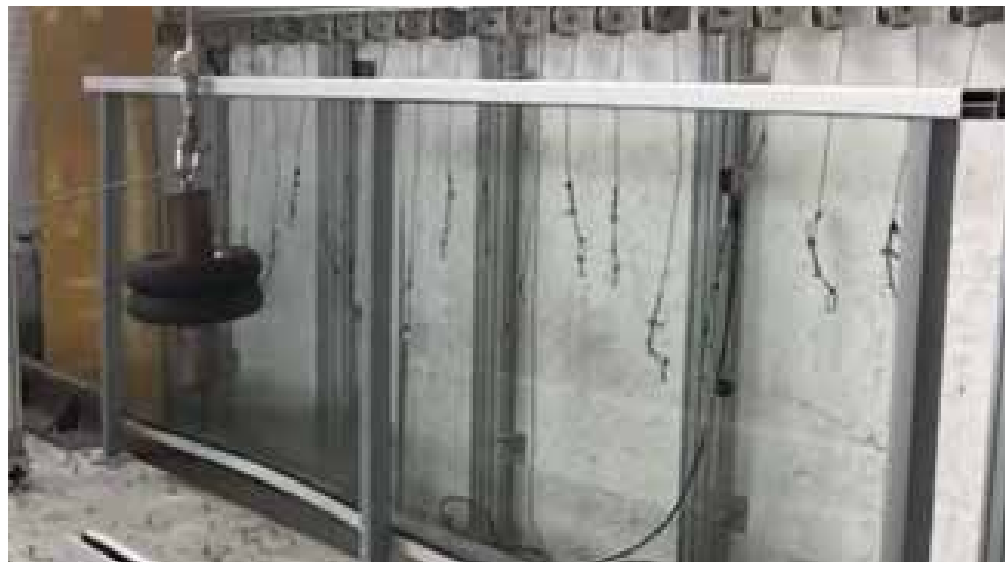
Prova di urto a 600 J con pendolo semirigido su modelli Maior con passo variabile dei piantoni e spessore vetro 6.6.2 PVB. In basso: prova superata con passo piantoni 1,5 m e dimensione vetro 1500x1000 mm;
