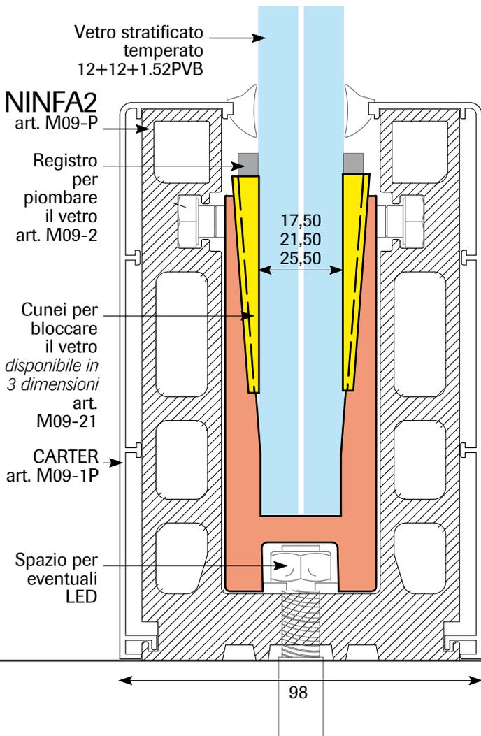
Sistema di montaggio per resistenza alla spinta classe 300 kg metro lineare.
